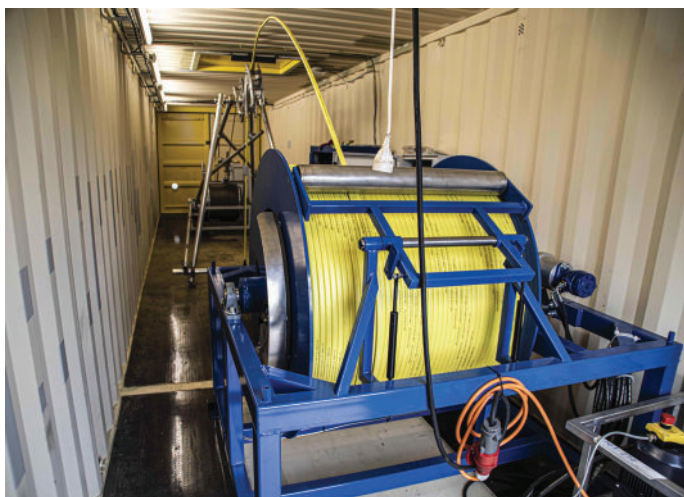
Figure 3 - Dispositif autour de la sonde permettant le monitoring gazier du sous-sol jusqu'à plus de 1 000 m. (Laboratoire GeoRessources, DR).
