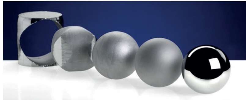
2. Sphère presque parfaite de silicium et les différentes étapes ayant mené à sa réalisation.
