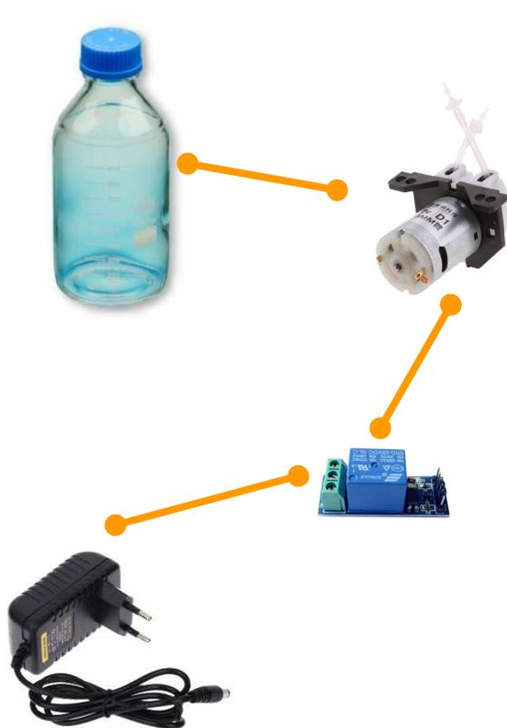
Actuation de la pompe sous tension constante (5V)
