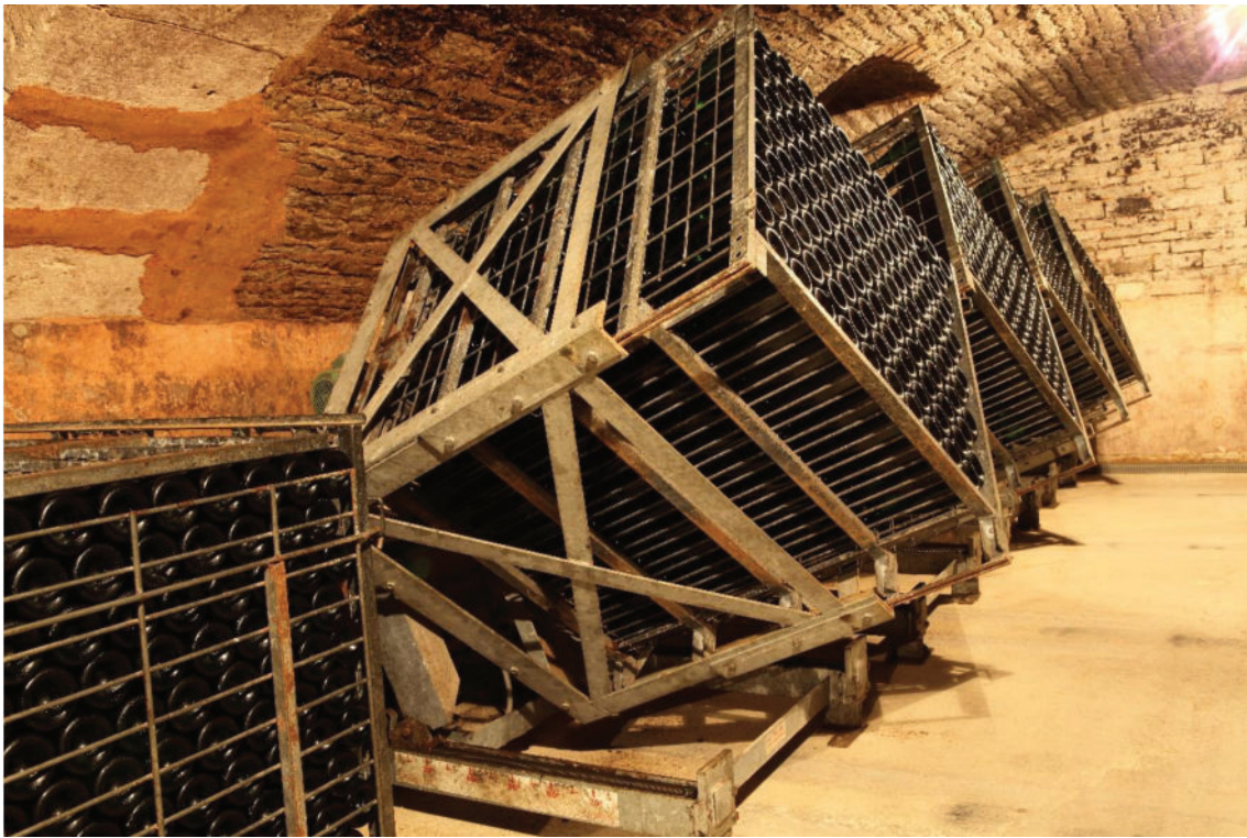
Figure 5 - Jadis exclusivement manuel, le remuage des bouteilles est aujourd'hui largement automatisé à l'aide de gyropalettes. (Rohrscheid et Michel Guillard/Collection CIVC, DR).
