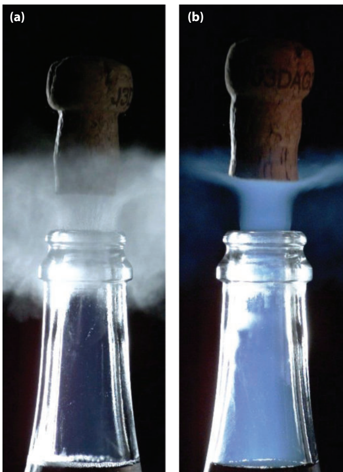
Figure 7 - Observation des phénomènes qui accompagnent le débouchage de deux bouteilles stockées respectivement à 6 °C (a) et à 20 °C (b) à l'aide d'une caméra rapide (Phantom Flex/ Vision Research, E.-U.). Les deux clichés ont été pris 1,2 ms après l'éjection du bouchon. (© Équipe Effervescence).
