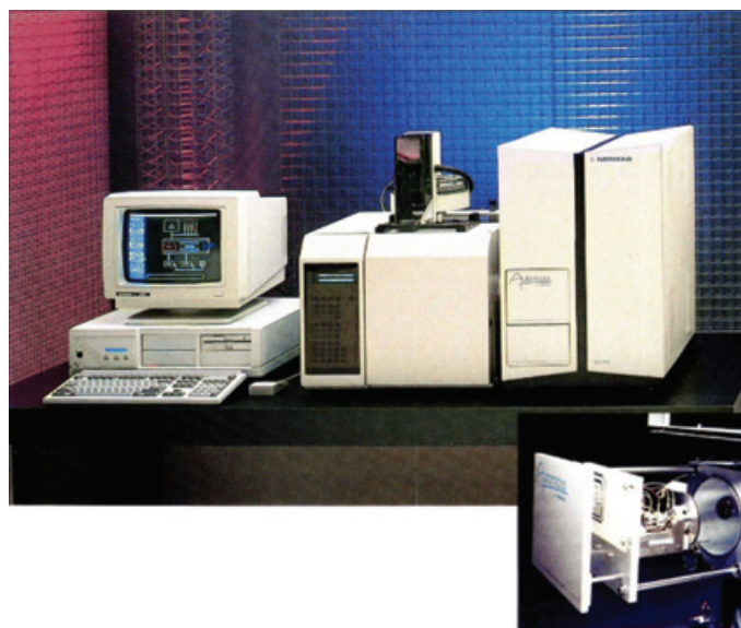
Figure 7 - Automass Delsi-Nermag System1 et sa source d'ions aisément accessible, associé à un chromatographe Delsi, en 1989.
