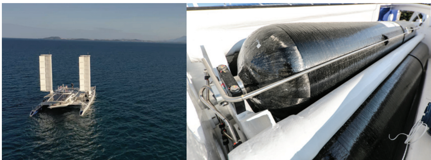
Figure 7 - « Bateau laboratoire », Energy Observer allie trois sources d'énergies renouvelables (solaire, éolien et hydrolien) et deux formes de stockage (batteries pour le court-terme et hydrogène pour le long terme). L'hydrogène est produit à bord grâce à une chaîne de production installée dans les flotteurs du navire, qui permet de désaliniser, purifier, électrolyser, comprimer et enfin stocker l'hydrogène dans huit réservoirs (www.energy-observer.org/fr). Crédits photos : bateau : © Energy Observer/David Champion ; réservoir : © Energy Observer/Jérémy Bidon.
