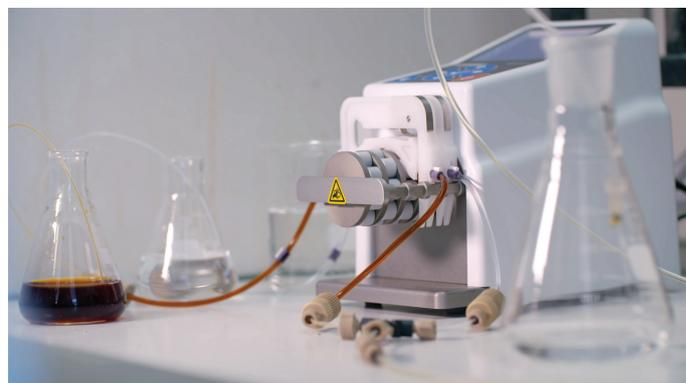
Figure 11 - Un dispositif de synthèse en flux continu.
