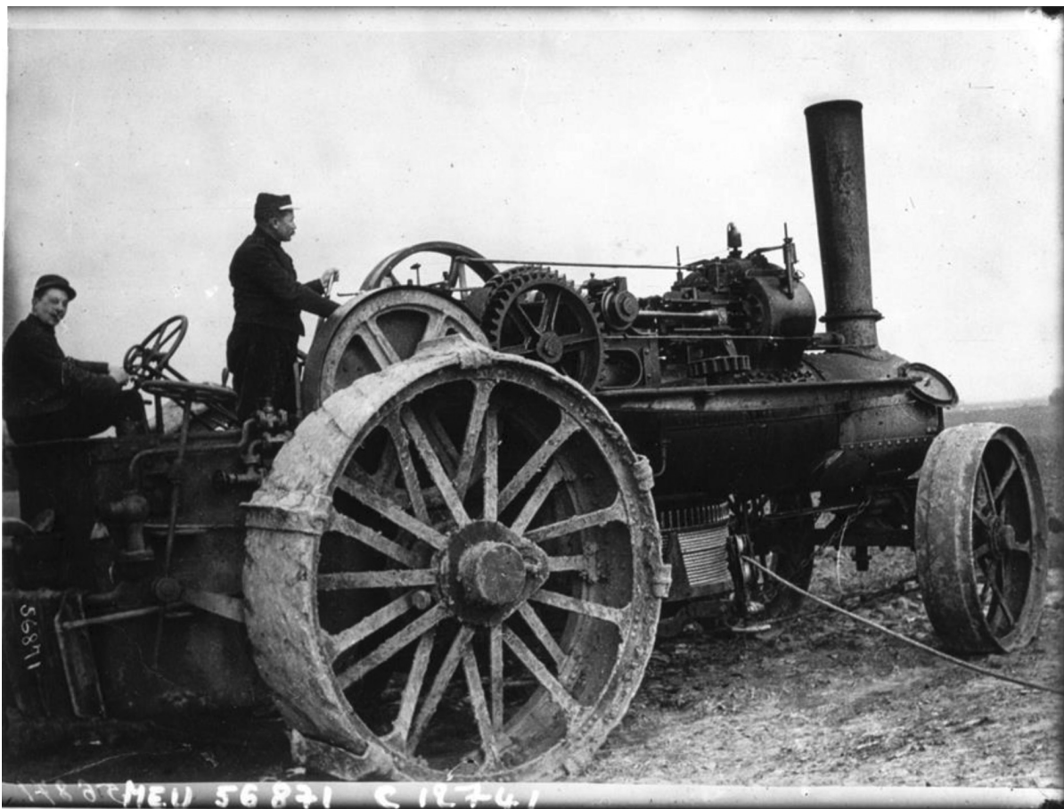
Figure 3 - Première Guerre : machine utilisée pour remettre en état les sols ravagés par les obus. © Galica.bnf.fr/Bibliothèque nationale de France.
