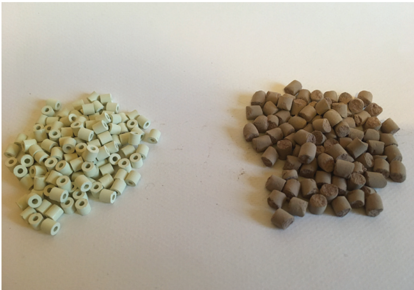
Catalyseurs d'oxydation au fer : à gauche, du méthanol ; à droite, du propylène.
