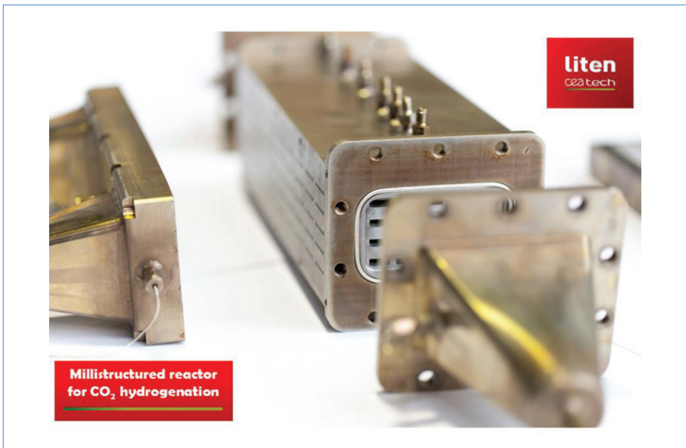
Figure 3 - Exemple de réacteur intensifié développé pour l'hydrogénation du CO 2 (désigné pour traiter 1 Nm 3 /h de gaz entrant).
