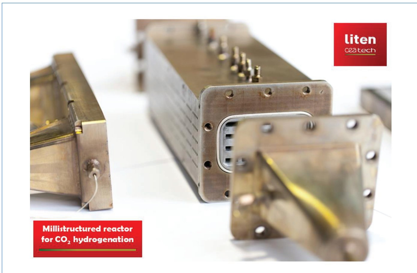
Figure 3 - Exemple de réacteur intensifié développé pour l'hydrogénation du CO 2 (désigné pour traiter 1 Nm 3 /h de gaz entrant).
