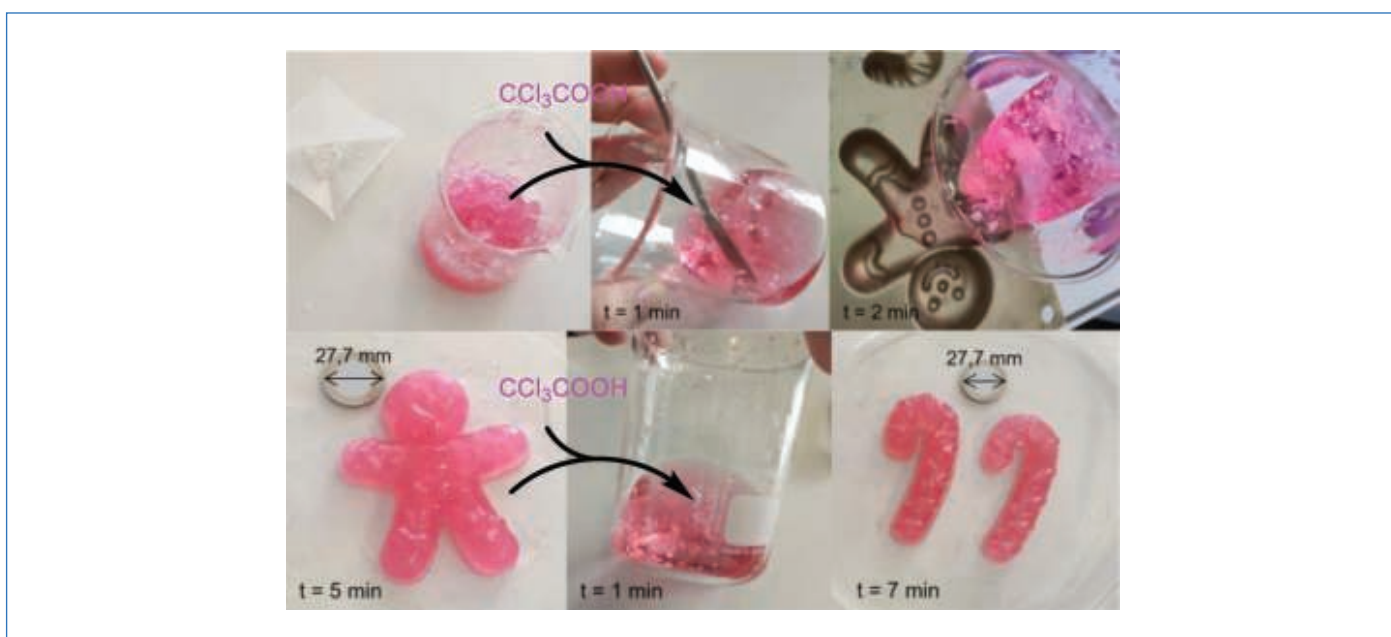
Figure 13 - Application du système gel-sol-gel à des moulages d'objets recyclables. Utilisation de rouge Congo comme colorant. (Reproduit de [39] avec autorisation, © 2022 American Chemical Society).
