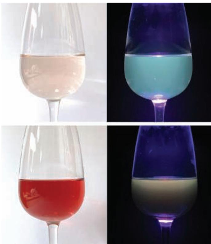
Figure 3 - Un vin rosé clair (Côte de Provence) et un vin rosé foncé (Tavel) observés en lumière blanche (à gauche) et sous une lampe torche UV posée sur le verre (à droite). Pour le second, la fluorescence s'atténue vers le bas en raison de l'absorption de la lumière par les anthocyanes et les tanins. © Bernard Valeur.
