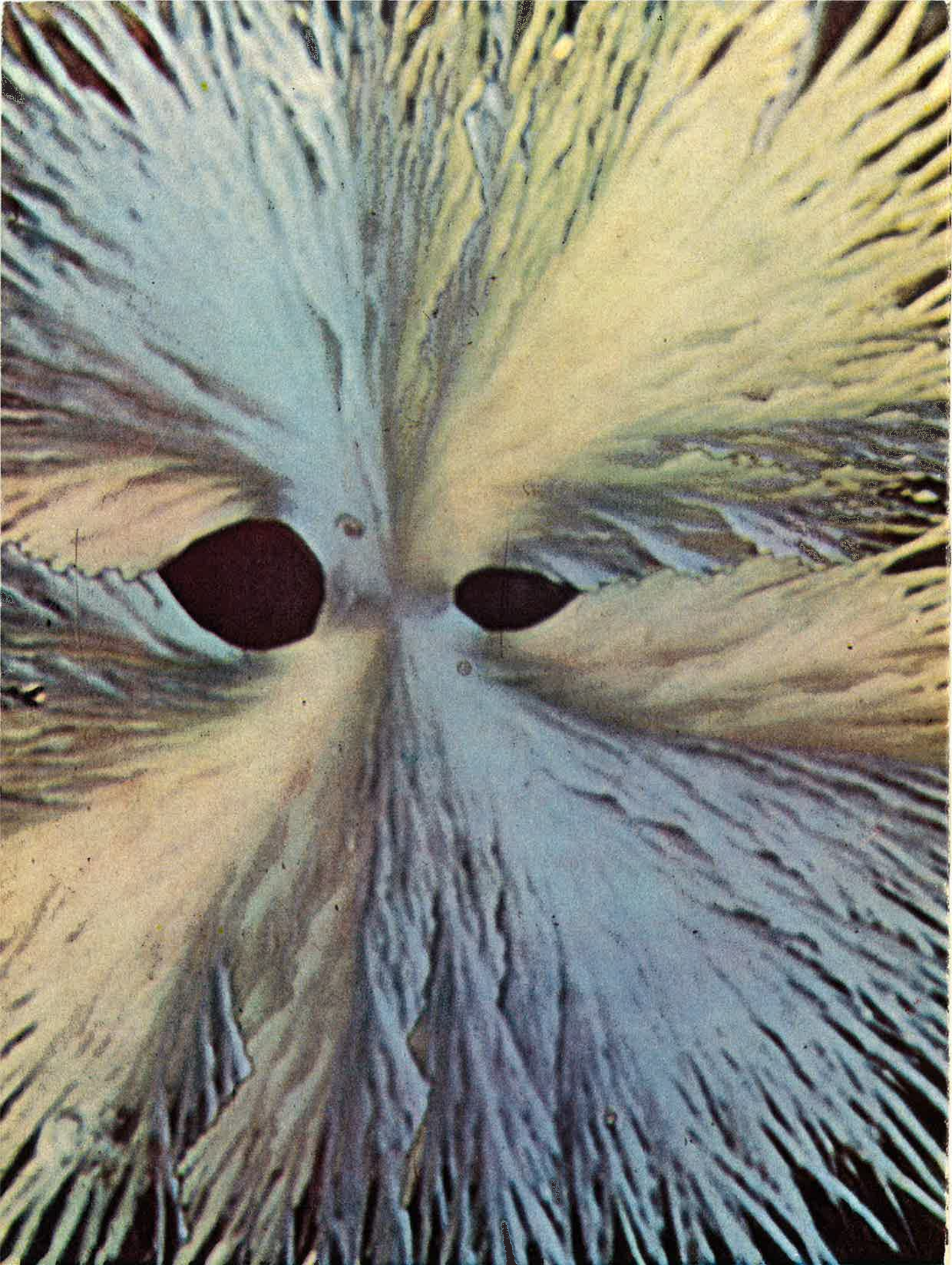
Sphérolites au faisceau de rikardite, \text{Cu}_4\text{Te}_3 , observé au microscope polarisant par transmission (C.N.R.S. Bellevue) (Photo Paparoditis)
