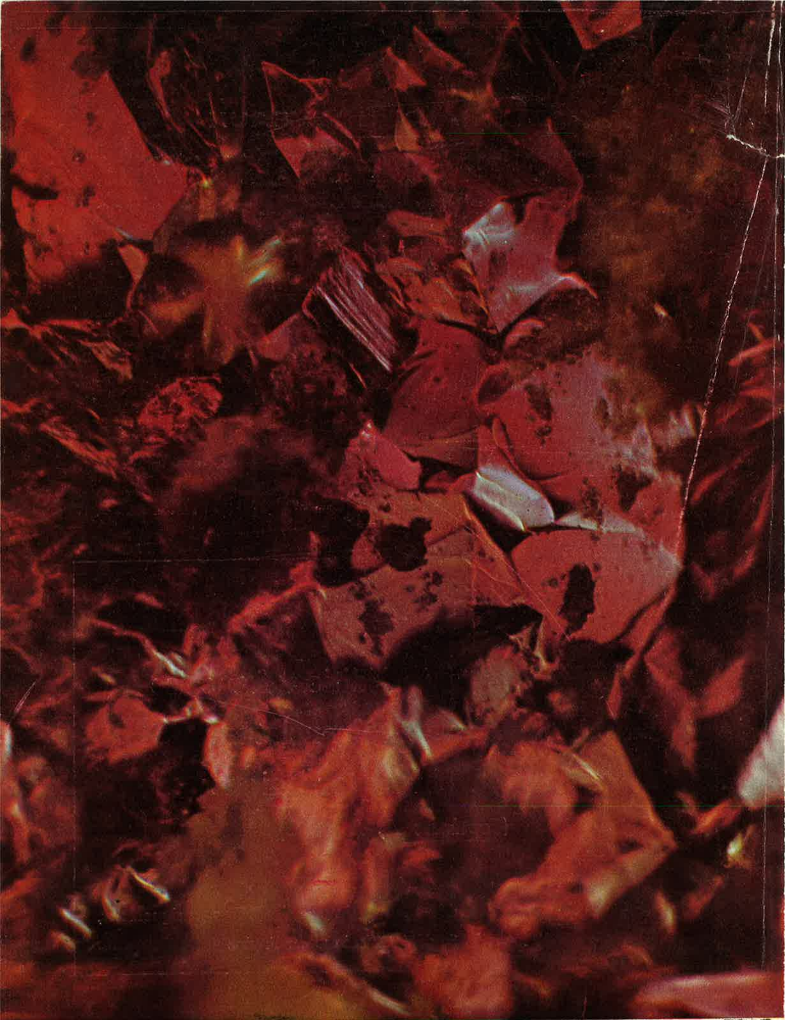
C.E.N. Saclay. Service S.E.P.C.P. Vue en fond noir à polarisation d'une vapedéposition de W sur un substrat de molybdène. Le dépôt est défectueux : on observe la présence de cavités emplies de cristaux verts (sels de W métallique). (Cliché Hasson).
