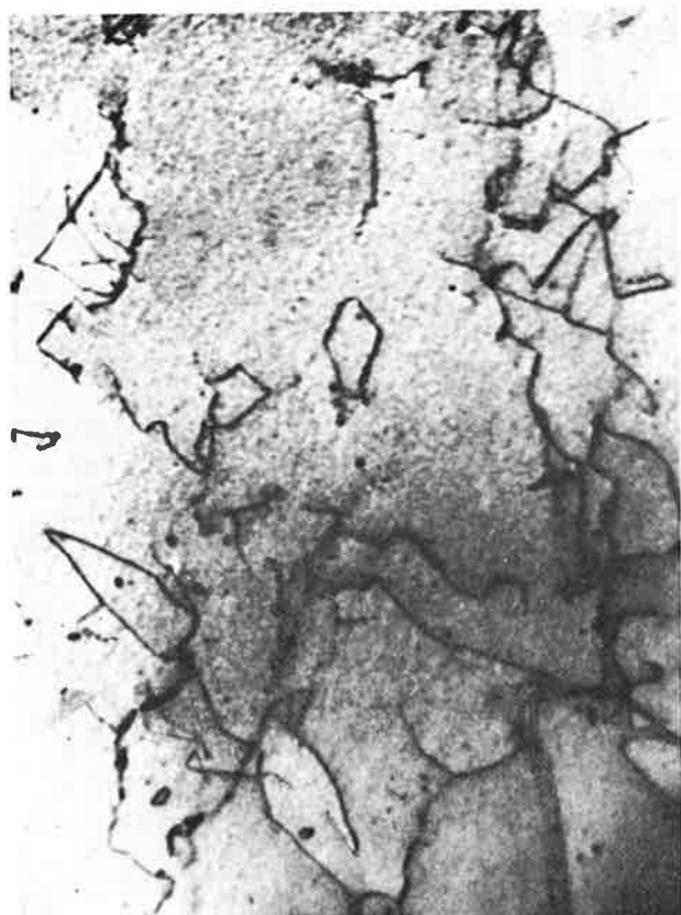
Figure 7. Dislocations enchevêtrées dans le fer Armco chargé en hydrogène ( \times 19\ 000 ).
