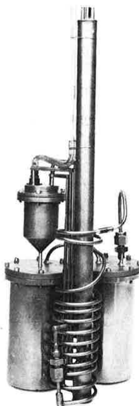
Figure 10. Vase réactionnel et vase d'absorption pour réactions entre gaz (avec production de solutions aqueuses d'acide fluorhydrique).
