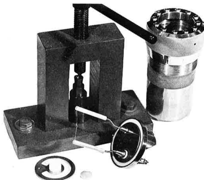
Figure 7. Dispositif de préparation des échantillons; porte-échantillon (4).
