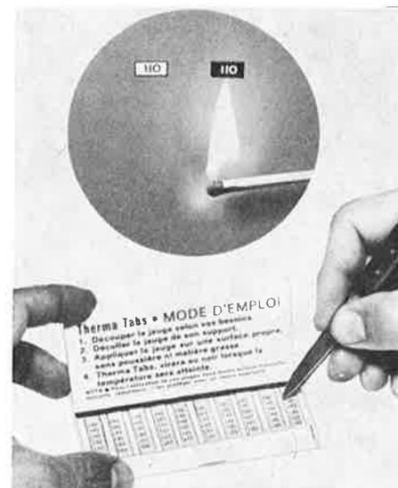
virent au noir en 1 seconde, de façon irréversible lorsque la température de consigne est atteinte. Cette température reste lisible. Elles peuvent être utilisées, en particulier, pour la surveillance d'étuves et chambres d'essais climatiques, la surveillance des températures de stérilisation, comme témoin d'échauffement incorporé à des systèmes pour l'application des garanties commerciales etc...
