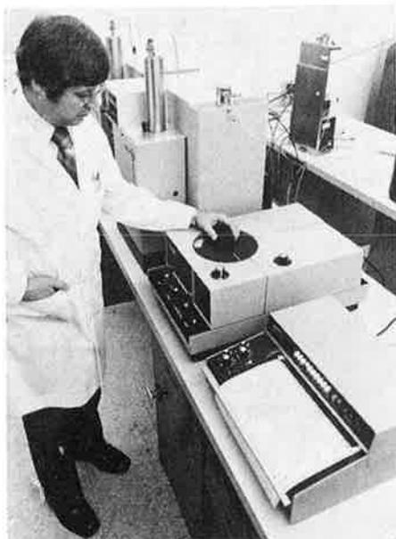
Une des caractéristiques les plus importantes du Varichrom est sa faculté de réglage en continu des longueurs d'onde. Cela permet d'observer n'importe quel composé à sa longueur d'onde optimale et mesurer ainsi la plus petite quantité détectable possible (M.Q.D., lowest minimum detectable quantity), tout en supprimant le bruit de fond.
