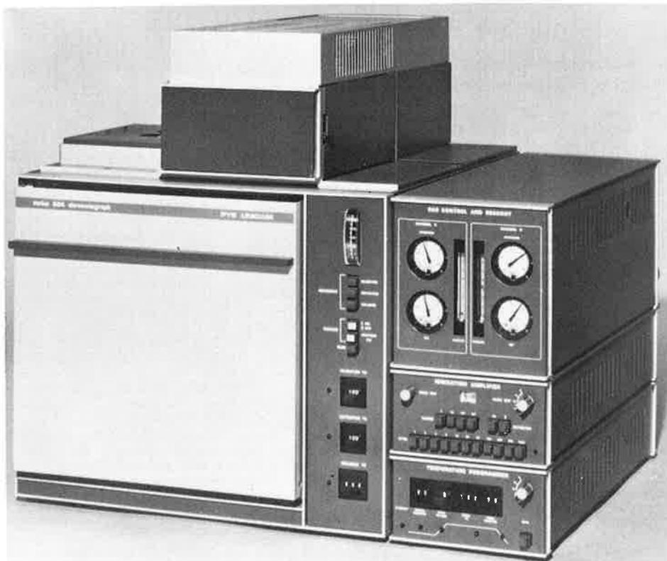
chromatographe double détecteur, double colonne, température programmée automatique, injecteur automatique...
