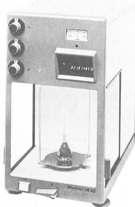
Le très vaste domaine de mesure électrique (2 g et 200 mg respectivement) se révèle particulièrement utile pour le dosage de substances diverses. Autre atout majeur : la possibilité de tarer par simple pression du doigt sur toute la zone de pesée (soit 160 g) ; l'indicateur avec chiffres lumineux à 7 segments affiche aussitôt zéro et
