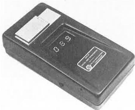
Le DHR 75 est disponible avec graduation en degrés Brix, poids spécifique de matière sèche ou en pourcentage. Il est compensé en température dans une plage de  $\pm 4^\circ\text{C}$  pour une température de référence de  $20^\circ\text{C}$ .
