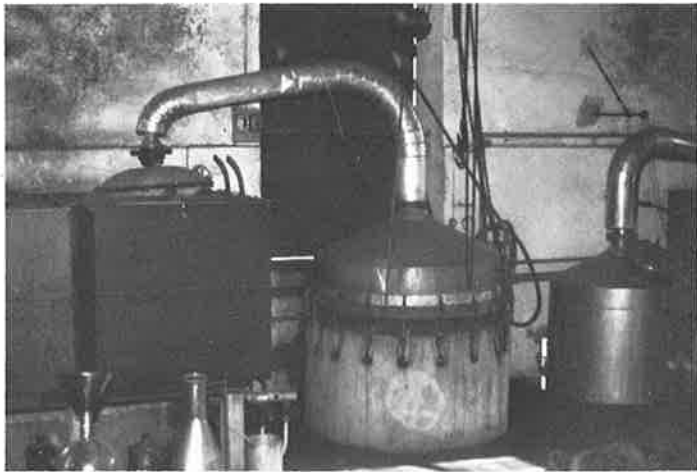
Alambic de distillation à la vapeur d'eau pour l'obtention des huiles essentielles. Sur la gauche de la photo, un récipient du «type Florentin» pour la séparation de l'huile essentielle et de l'eau d'entraînement.
