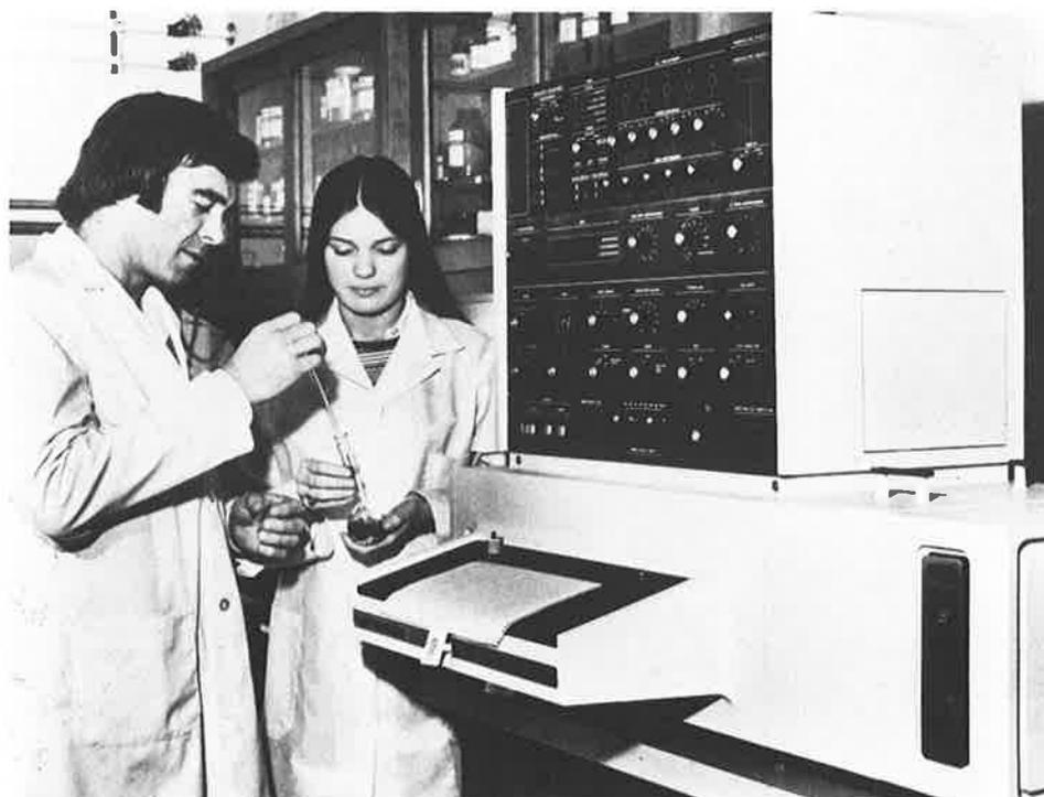
Commercialisé sous le nom de "Spectrophotomètre UV-Vis, Varian Cary modèle 219", le nouvel appareil a une résolution meilleure que 0,07nm, ainsi qu'une lumière parasite inférieure à 0,002 % à 220nm. La linéarité photométrique est de 0,0016 à 1 D.O. et 0,03 à 3,0 D.O.
