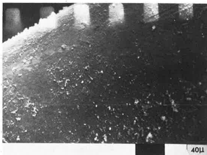
Figure 13. Effets couronne (+). Surface du fil après la production d'un courant par effet couronne (+) de 140\ \mu\text{A}/\text{cm}^2 pendant \approx 15 heures.
