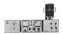
Les performances de l'ensemble se résument ainsi : sensibilité DT = 0,005 °C à 0,5 °C par mm suivant le modèle et le gain de l'ampli, bruit de fond 0,05  $\mu$ V pK pK, dérive 0,2  $\mu$ V/h/°C.
