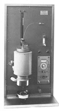
La manœuvre est la plus simple possible : introduire dans son logement le bac avec l'échantillon d'huile à tester, appuyer sur un bouton : attendre 5 secondes et lire la courbe de drasticité.
