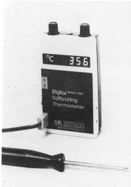
les domaines de température à étudier; la précision de la lecture est de 0,1 %. Le thermomètre peut être alimenté par des piles et des accu rechargeables, son poids est de 230 g. Il est vendu dans une valise avec un chargeur.
