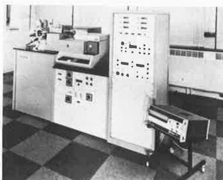
Tout comme le MS 25, le MS 80 est doté du dispositif ACE (balayage alternatif ionisation chimique - impact électronique) qui permet d'obtenir les spectres IE et CI de chaque pic chromatographique à partir d'une seule injection et ce, même en colonne capillaire (temps de commutation inférieur à la seconde).
