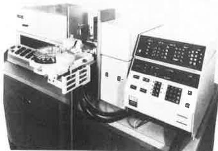
L'instrument offre une méthode automatique d'addition utilisant deux procédures et la modification automatique de la matrice. L'étalonnage automatique des Modèles 5000, 703, 603, 560 ou 460 est également incorporé. L'étalonnage et la pente peuvent être réglés à nouveau jusqu'à trois fois pendant le fonctionnement. Dans la version 5000/HGA-500/AS-40 ce dernier appelle les programmes du spectro-
