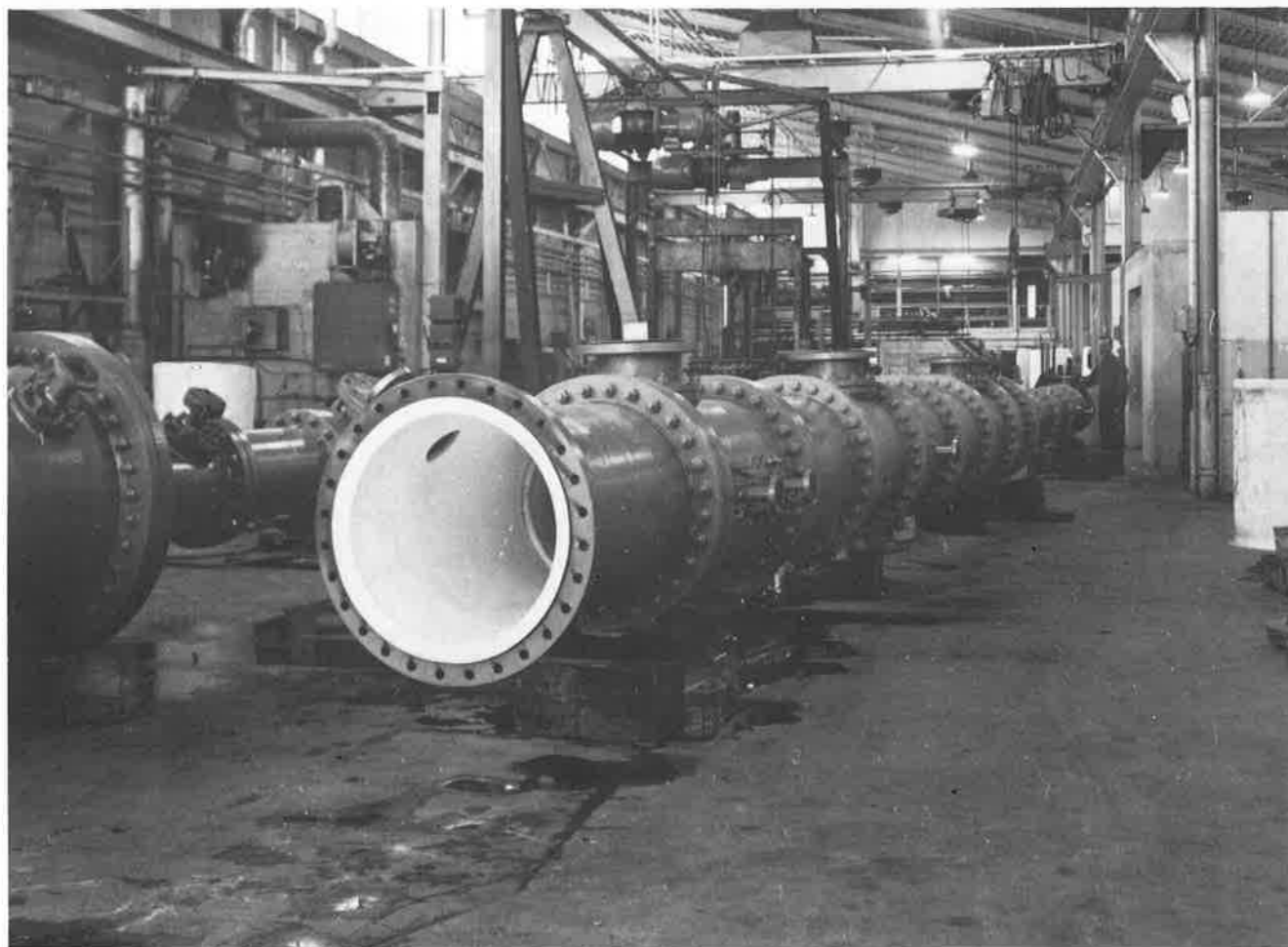
Assemblage d'éléments cylindriques permettant de réaliser des longueurs de colonne quelconques.
