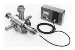
La tête homogénéisante Ultra-Son offre la possibilité de contrôler et de reproduire le traitement. Cela se réalise par l'ajustement de la configuration du jet liquide qui débouche de l'orifice. La lame est montée sur un bloc d'acier inoxydable qui se met aussi à résonner (ce qui augmente le niveau des vibrations dans le matériel à traiter). Un sensor à cristal est attaché à ce bloc, et on peut noter l'ajutage qui donne le meilleur rendement acoustique pour une utilisation donnée.
