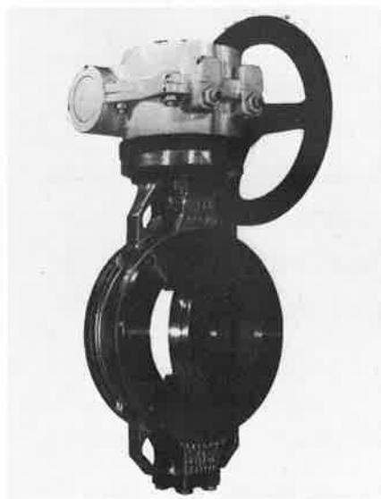
clapet. Ce clapet est entraîné en rotation par l'arbre cannelé, lui-même guidé dans sa partie supérieure par une bague adaptée aux températures de service. Un seul presse-étoupe surélevé, boulonné et resserrable, assure l'étanchéité à la sortie de l'arbre. De même, dans sa partie inférieure, l'arbre est guidé par une bague insérée dans le carter inférieur du corps du robinet obturé par un couvercle à double emboîtement et un joint.
