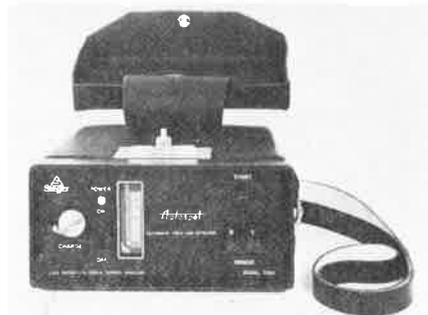
tes, les amines, l'anhydride sulfureux, le formaldéhyde, l'hydrazine, l'ammoniac etc. A chaque gaz correspond une carte de détection, portant le papier sensible, sur laquelle sont imprimés l'échelle de détection et les deux numéros de code.
