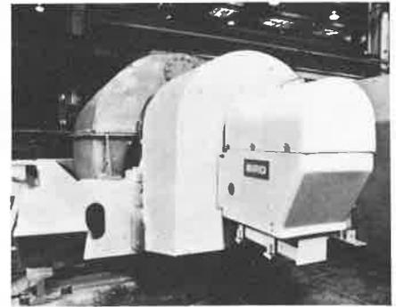
Les centrifugeuses utilisées pour la production de polymères (PVC, polyéthylène, polypropylène, polystyrène et alcool polyvinyle) traitent habituellement une boue composée de 30 % de solides en suspension et de 70 % d'eau. Jusqu'à maintenant, les fabricants avaient maintenu un fort pourcentage d'eau pour éviter ces « vibrations » liées au gâteau sec.
