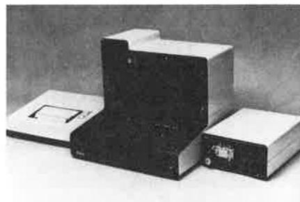
Outre les vingt et un types de courbes disponibles en gradient d'élution, la programmation de température du four à colonnes, la température des éluants, l'atténuation des détecteurs, le balayage des longueurs d'ondes, la vitesse de l'enregistreur, l'injection automatique, le « stop-flow », etc. sont directement gérés par le microprocesseur.
