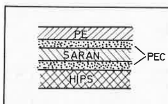
Figure 26. Structure d'une feuille coextrudée et formée par la superposition en couches de différents polymères.
