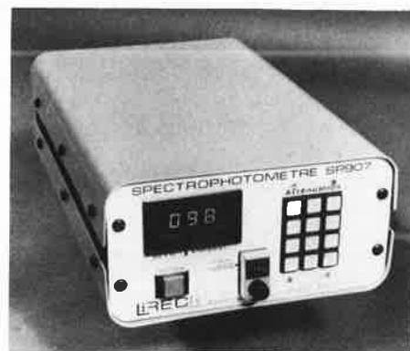
Sur le modèle SP. 907, la commande « zéro de ligne de base » est automatique et télécommandable par fermeture d'un contact. La sensibilité est choisie à l'aide d'un clavier à touches lumineuses.
