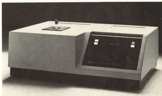
Le microprocesseur intégré et le générateur d'impulsions programmable permettent d'utiliser n'importe quelle séquence d'impulsion et de les mémoriser (sur des petits circuits intégrés interchangeables). Le microprocesseur permet, d'autre part, d'accumuler les signaux, et ainsi, d'obtenir une meilleure sensibilité.
