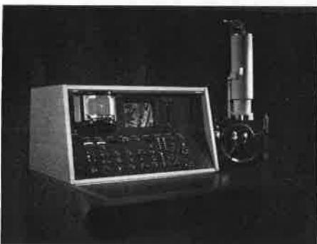
A ces caractéristiques du traitement de l'image, il faut ajouter une qualité d'image obtenue sans précédent qui est due au balayage lent additionné au moniteur haute résolution 4 000 lignes.
