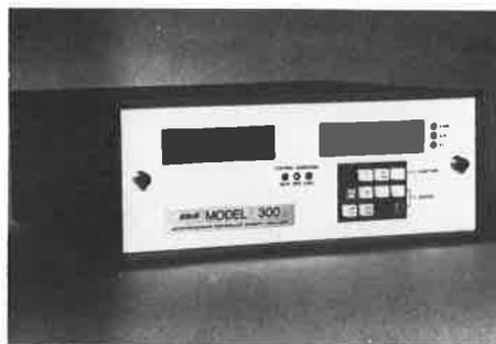
Conçu également pour recevoir l'information température sèche ou la pression du gaz contrôlé, le modèle 300 peut afficher simultanément la température du point de rosée et la température sèche ou l'humidité relative soit en %, en ppm, ou encore le poids d'eau.
