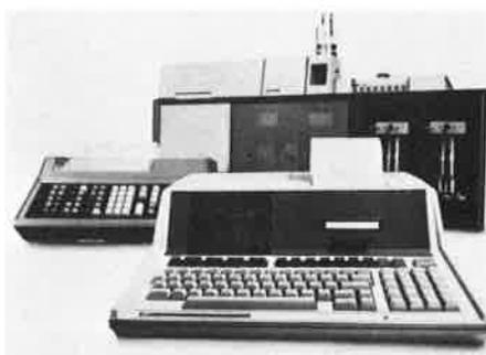
un stockage permanent important des programmes et des données. Les deux claviers indépendants, type « machine à écrire » et « calculatrice » donnent une vue très claire de toutes les fonctions du système; l'imprimante thermique interne fournit, sur une simple pression de touche, une copie de l'affichage.
