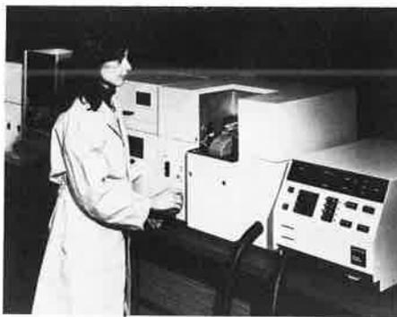
Le Z/5000 peut s'utiliser avec l'échantillonneur automatique AS-40 pour la détermination séquentielle automatique de 6 éléments dans un nombre d'échantillons pouvant aller jusqu'à 35, y compris addition standard et modification de matrice complètement automatiques.
