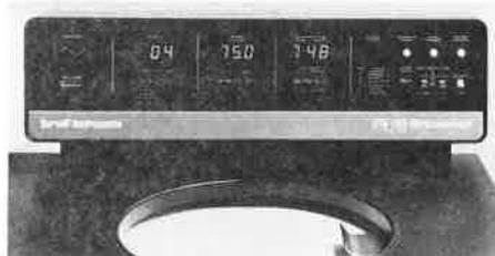
Le thermostat des centrifugeuses OTD-B permet de régler la température entre 0 et 40 °C à  $\pm 1$  °C. Ces appareils comportent, en outre, un mode automatique et un mode manuel de mise sous vide et ils permettent le montage d'un grand nombre de rotors, y compris la plupart des rotors pour ultracentrifugeuses provenant d'autres fabricants.
