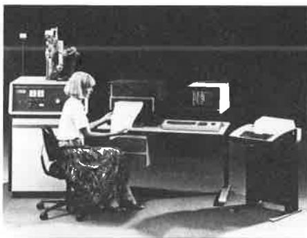
L'interface série à deux portes (RS 232 C/V 24) autorise sa liaison avec deux terminaux entrée/sortie qui peuvent être une téléimprimante, un écran vidéo, un miniordinateur programmable.
