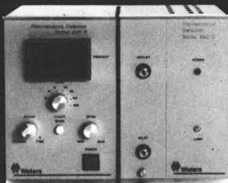
5 DETECTEUR FLUORIMETRE A FILTRES "M 420"
