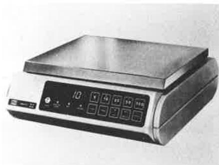
développée par G.S.E. pour ce type de produits; cette balance bi-fonction utilise comme détecteur une poutre équipée de jauges d'extensométrie à trame métallique; cette poutre est dite montée « flottante » et les jauges sont placées en son centre; le découplage du système est tel que la position des pièces à compter ou à peser sur le plateau sont sans influence sur le résultat.
