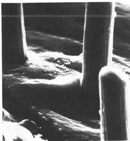
Tissu osseux poussant autour de filaments de carbone renforcés de fibre de carbone. Les fibres ont un diamètre de 8 \mu\text{m} . (Photo de D.H.R. Jenkins).
