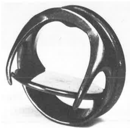
Valvule du cœur fabriquée au Brésil en carbone vitreux. De forme complexe, la prothèse est fortement polie. C'est un exemple remarquable des pièces que l'on fabrique en carbone monolithique.
