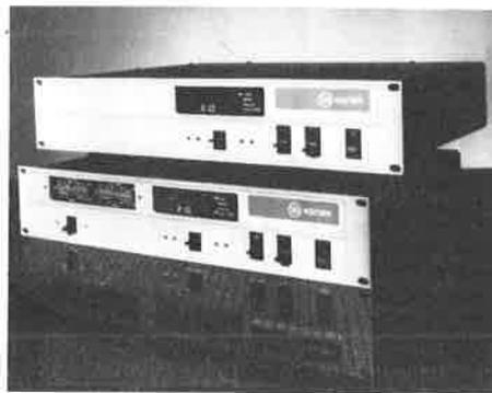
Les deux modèles 880-1 et 880-2TC sont dotés d'un microprocesseur, d'une commutation électronique automatique des gammes, d'un affichage numérique LED facilement lisible pour la mesure de pression (Torr, millibar ou Pascal) ainsi que d'un système d'autodiagnostic à affichage d'erreur. La sortie BCD à mémoire intermédiaire pour branchement à un ordinateur fait partie de l'exécution
