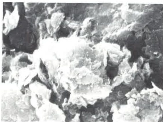
Grain de catalyseur vu au SEM ( \times 2\,000 ) ; petits feuillets graphitiques agglomérés.
