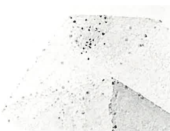
Cliché au CTEM ( \times 600\,000 ) particules de platine (1-1,5 nm) en bout de feuillet.
