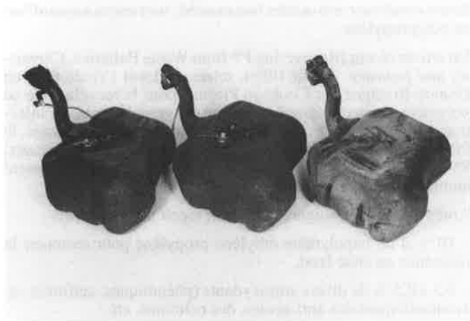
FIGURE 2. - Réservoirs d'automobile en PEHd, nettoyés au jet de vapeur (à gauche), au jet de sable (au centre), non traités (à droite).
