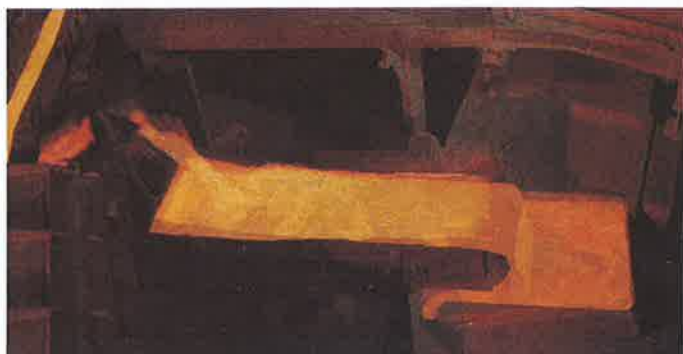
Photographie II C 2 : Coulée du cuivre impur (99,5 %) sous forme d'anode, au Palais-sur-Vienne (Haute-Vienne) - Documentation C.G.E.P. (Pechiney).
