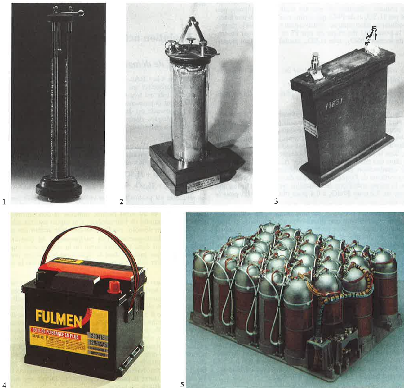
FIGURE 1. - Évolution des générateurs électrochimiques : 1) pile de Volta ; 2) accumulateur de Planté, modèle 1860 ; 3) accumulateur de Planté, modèle 1868 ; 4) batterie de démarrage, 1990 ; 5) accumulateur nickel-hydrogène haute pression pour satellites, 1990. (1, 2 et 3 : Musée National des Techniques - CNAM/Paris).
