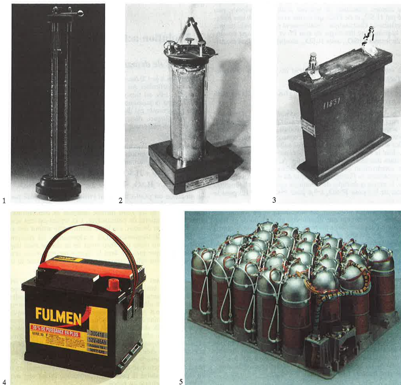
FIGURE 1. - Évolution des générateurs électrochimiques : 1) pile de Volta ; 2) accumulateur de Planté, modèle 1860 ; 3) accumulateur de Planté, modèle 1868 ; 4) batterie de démarrage, 1990 ; 5) accumulateur nickel-hydrogène haute pression pour satellites, 1990.
