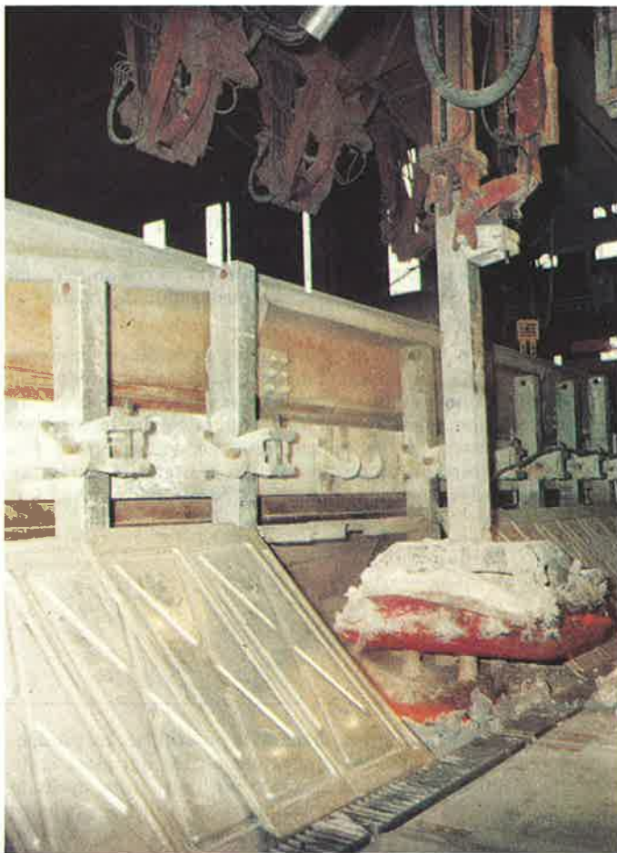
Photographie III A 1 : Changement d’anodes dans une cuve de production d’aluminium - Documentation Aluminium Pechiney.
