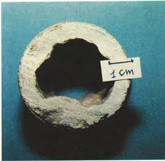
Photo 1. - Obturation de canalisations par des dépôts de tartre (distribution d'eau dans la région parisienne). Photographie W. Lin.
