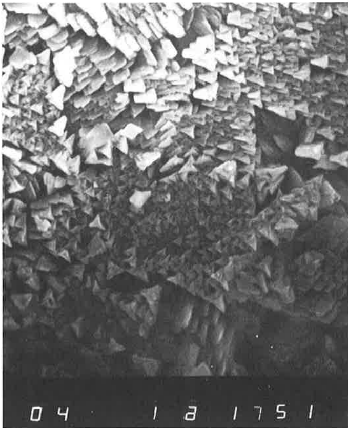
Carbonate de calcium ; eau non traitée. MEB, grossissement \times 1\,000 .
