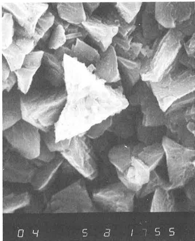
Carbonate de calcium ; eau non traitée. MEB, grossissement \times 5\ 000 .
