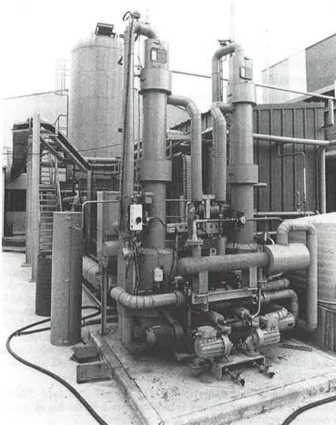
Photographie II D 1 : Production électrolytique d'hydrogène - Unité 2,4 MW du Pont-de-Claix (Isère) - Documentation Rhône-Poulenc.
