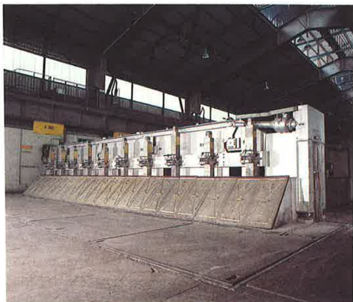
Photographie III A 2 : Cuve 295 kA de production d'aluminium - Dunkerque (Nord) - Documentation Aluminium Pechiney.
