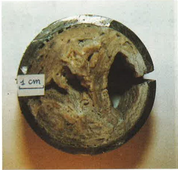
Photo 1. - Obturation de canalisations par des dépôts de tartre (distribution d'eau dans la région parisienne). Photographie W. Lin.
