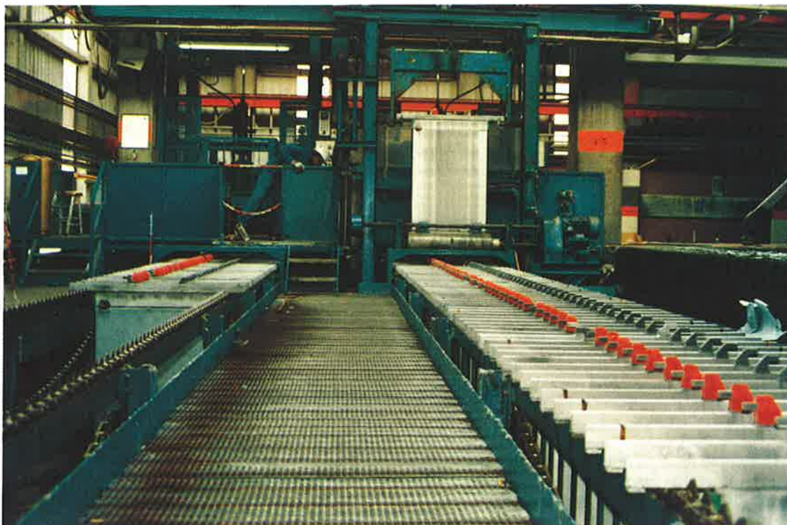
Photographie II C 3 : "Stripping" des cathodes - Production électrolytique du zinc - Documentation Vieille Montagne.
