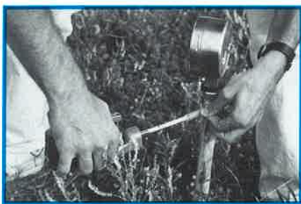
Détail de mesure de la concentration des gaz dans les sols (tube Draeger).
