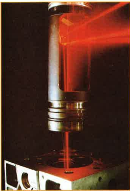
Photo 3 - Principe du moteur transparent pour l'analyse des propriétés des gaz dans la chambre de combustion par des techniques laser. (Source : IFP)
