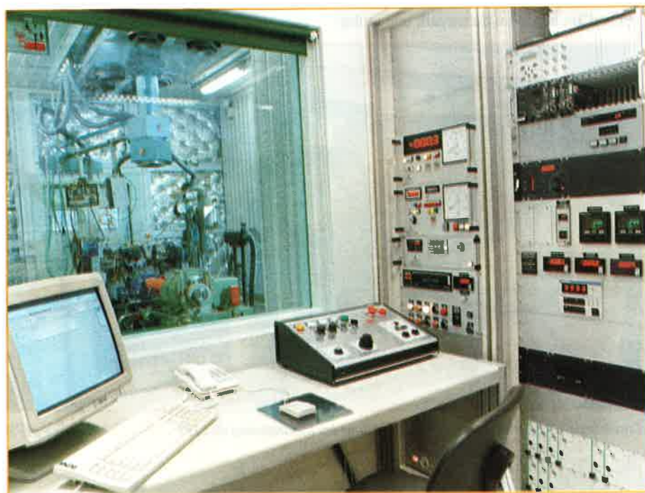
Photo 1 - Cellule d'essai moteur - Poste de travail face à la baie vitrée pour l'observation de la cellule. (Source: IFP)
