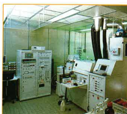
M. Mazza : "Le spectromètre ICP-masse haute résolution est dans une salle climatisée dont l'accès est très réglementé. Les gaz dangereux utilisés font l'objet d'un contrôle par détecteurs et alarmes. Il ne fonctionne jamais sans la présence d'un spécialiste".
