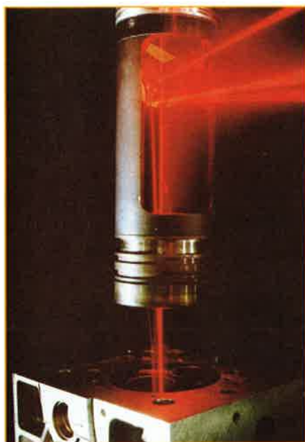
Photo 3 - Principe du moteur transparent pour l'analyse des propriétés des gaz dans la chambre de combustion par des techniques laser. (Source : IFP)
